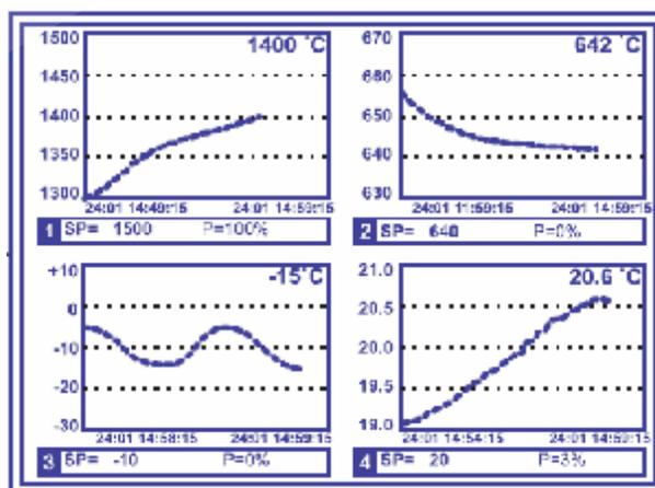
Второй – выводит крупно график по одному из каналов. Для того чтобы в этом режиме перейти на другой канал используйте кнопки «▼» и «▲». Для сдвига графика используйте кнопки «▶» и «◀».
