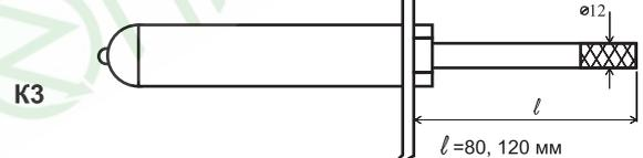
Контроль температуры жидких и сыпучих пищевых и непищевых сред в трубах и емкостях, например: воды в системах отопления и водоснабжения, молока в установках пастеризации, жидкости в системе охлаждения и т.д.
