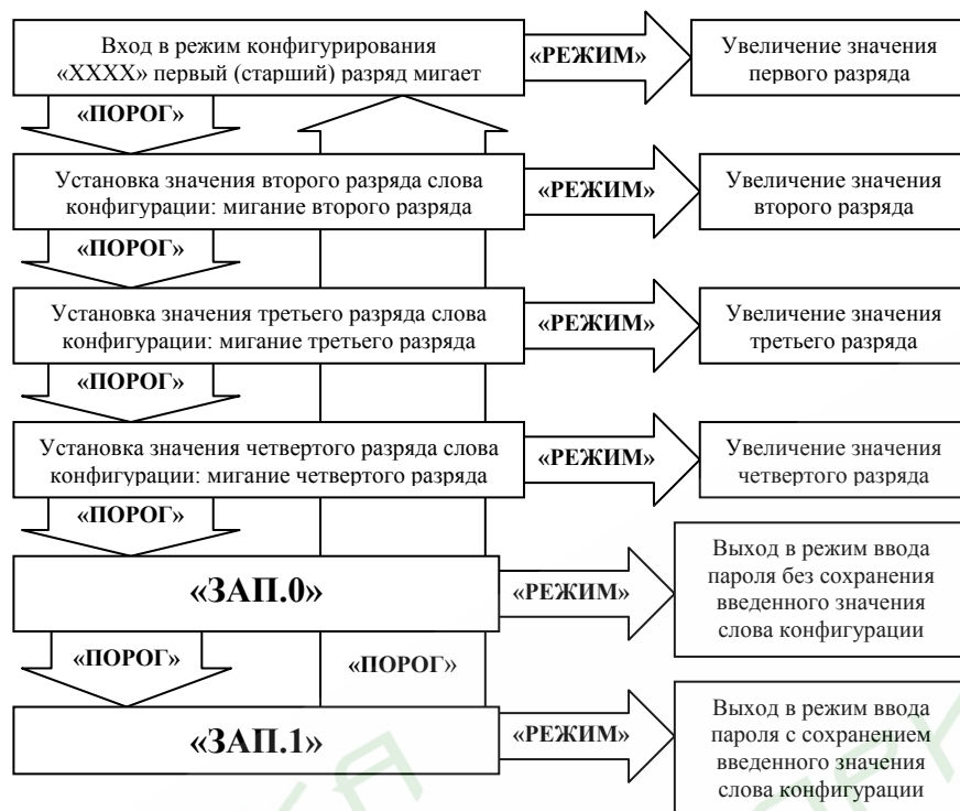
Рис.14. Алгоритм ввода конфигурации.
