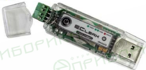
Рисунок 1 – Внешний вид автономного регистратора температуры двухканального ECLERK®-USB-2Pt
