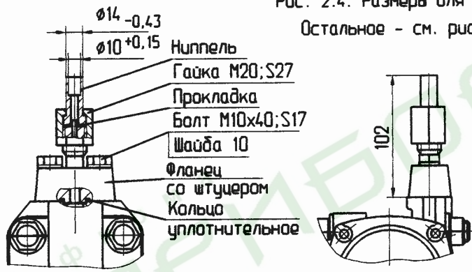
Рис. 2.5. Размеры для КМЧ Н20, Н21 Остальное – см. рис. 2.1...2.4
