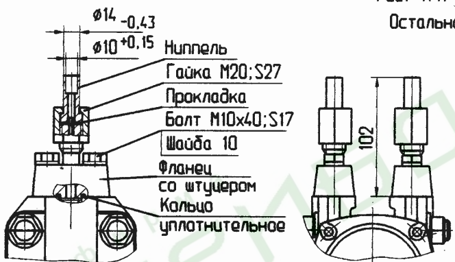
Рис. 1.5. Размеры для КМЧ Н11, Н12 Остальное - см. рис. 1.1...1.4
