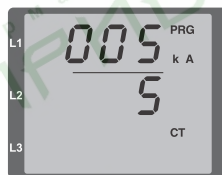
Рис. Режим программирования трансформаторов тока С помощью кнопок 1 и 2 можно изменить первичный и вторичный ток (см. стр. 40).
