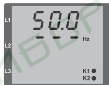
Рис. Установить направление вращающегося поля невозможно.
