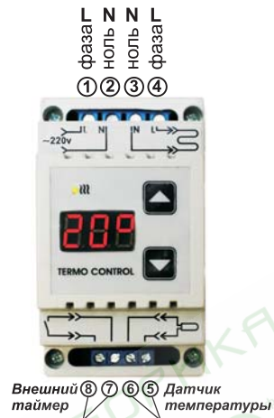
Рисунок 2 — Схема электрического подключения.
