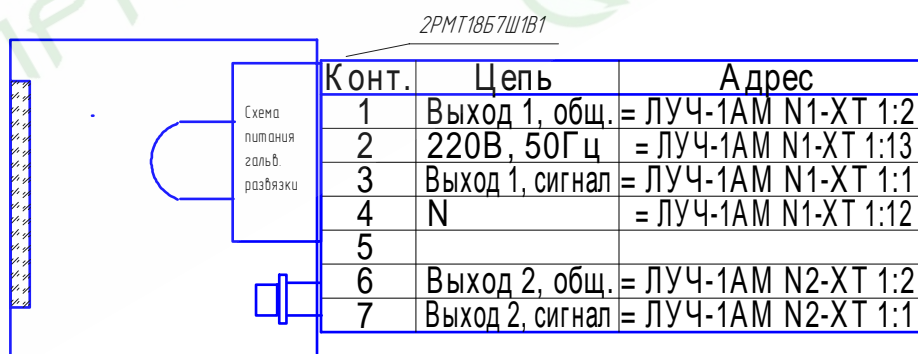
Рис.11. Выходные электрические цепи фотодатчика ФД-05ГМ.
