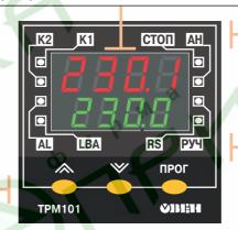
**Нижний цифровой индикатор** зеленого цвета отображает значение параметра при программировании
