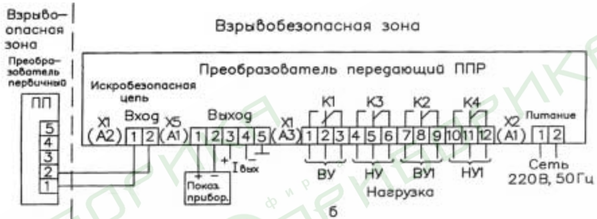
Рис. 5. Схема электрическая подключений датчика-индикатора уровня: а – РИС 101М, б – РИС 101МИ.
