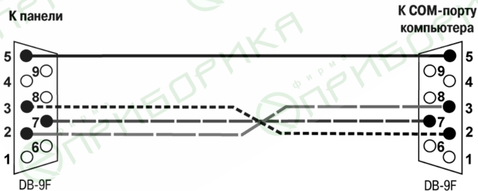
Рис. В.2. Соединительный кабель для конфигурирования панели с ПК
