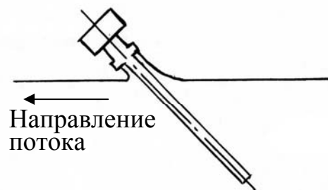
Рис.4. Установка ТУДЭ М1 на трубопроводе большого диаметра
