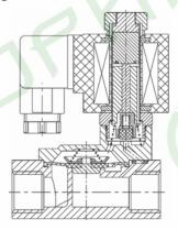
Клапан электромагнитный (соленоидный) YCD21 нормально закрытый, прямого действия, с мембранной. Используется только на системах с давлением от  $0.03~\mathrm{M}\Pi a$ .
