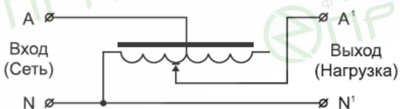
Регулирование напряжения осуществляется за счет изменения коэффициента трансформации. При перемещении графитовой щетки по обмотке автотрансформатора изменяется коэффициент трансформации и, как следствие, выходное напряжение. При коэффициенте трансформации, равном 1, вся электрическая энергия из сети передается в нагрузку.
