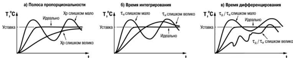
Рисунок Г.3 – Примеры графиков переходной функции
