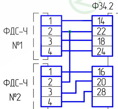
Рис. 4 Схема подключения фотодатчика к прибору Ф34.2.
