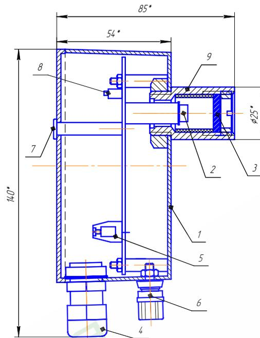
Рис.2 Конструкция фотодатчика
