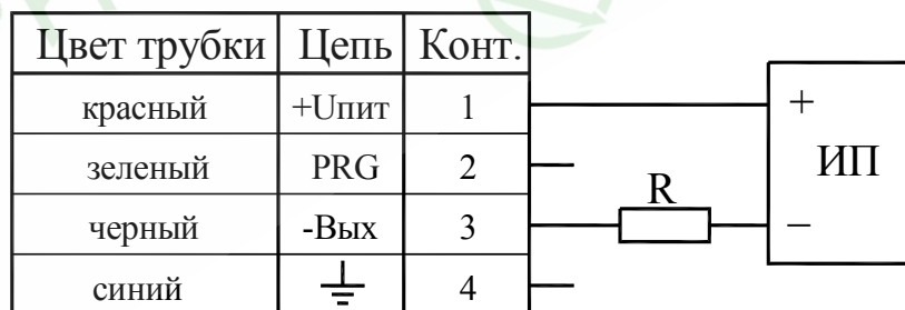
Выходы кабеля маркированы цветными трубками
