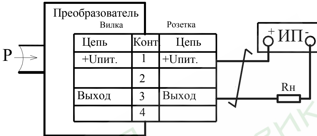
Рисунок Б.1 – Схема подключения преобразователей общепромышленного исполнения
