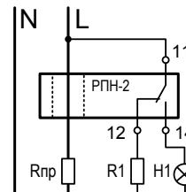
Схема включения реле РПН-2 для управления одной не приоритетной нагрузкой в режиме постоянного контроля тока
