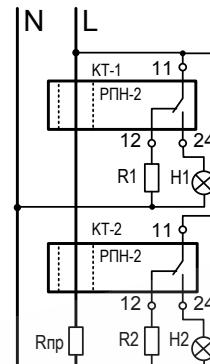
Схема включения 2-х реле РПН-2 для управления двумя не приоритетными нагрузками в режиме постоянного контроля тока
