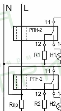
Схема включения 2-х реле РПН-2 для управления двумя не приоритетными нагрузками в режиме повторного включения
