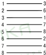
Рисунок Г.4 – Разводка с пересечением (crossover) кабеля для соединения контроллера с компьютером по сети Ethernet напрямую
