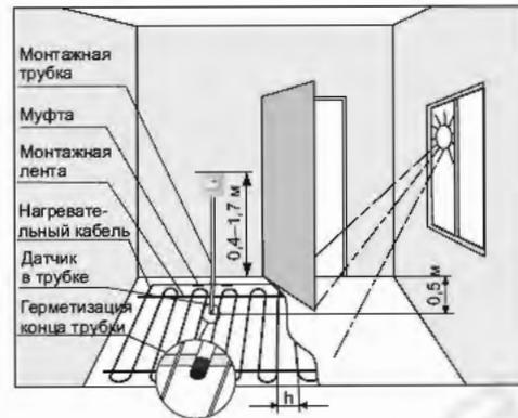
Рисунок 1. Монтаж терморегулятора и системы теплый пол
