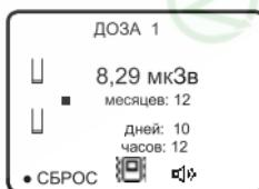
Нажатие кнопки «СБРОС», во время индикации экрана «ДОЗА», обнуляет накопленную дозу.
