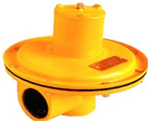
**Пружинный клапан** сбросной предназначен для ограничения давления неагрессивных газов путем сброса газа в атмосферу до установленной величины при повышении давления в сети сверх допустимого предела.
