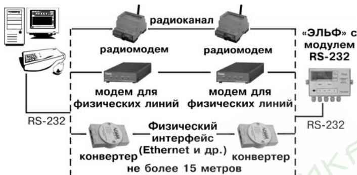
Рисунок 1.1 Варианты применения интерфейсного модуля RS-232
