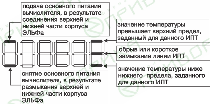
Рисунок 2.9 - Расшифровка кодов причин нештатной ситуации, отображаемой в поле дополнительной информации, при измерении температуры.
