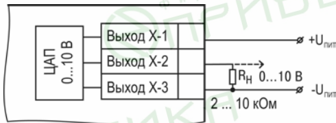
Рисунок 5.21 – Схема подключения нагрузки к ВУ типа У
