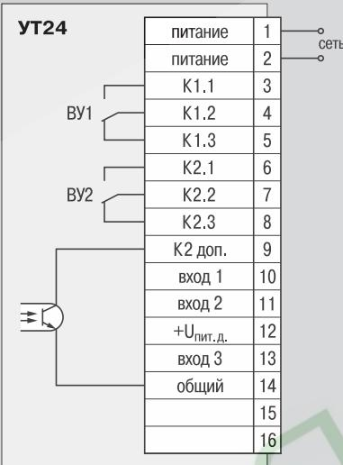
▲ Схема подключения прибора УТ24 с релейным выходом
