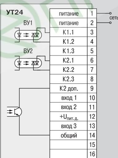
▲ Схема подключения прибора УТ24 с оптосимисторным выходом
