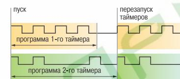
4. По окончании выполнения программы 1-м таймером происходит запуск (перезапуск) 2-го таймера
