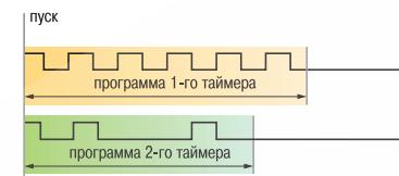
2. По окончании выполнения программы 1-м таймером запускаются оба таймера
