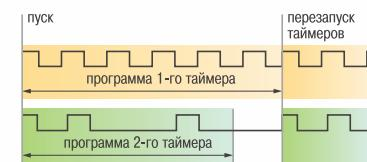
3. По окончании выполнения программы 2-м таймером запускаются оба таймера
