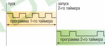
5. По окончании выполнения программы 2-м таймером происходит запуск (перезапуск) 1-го таймера
