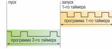
6. Поочередный запуск (перезапуск) таймеров: по окончании работы 1-го таймера запустится 2-й таймер, а по окончании работы 2-го таймера запустится 1-й таймер
