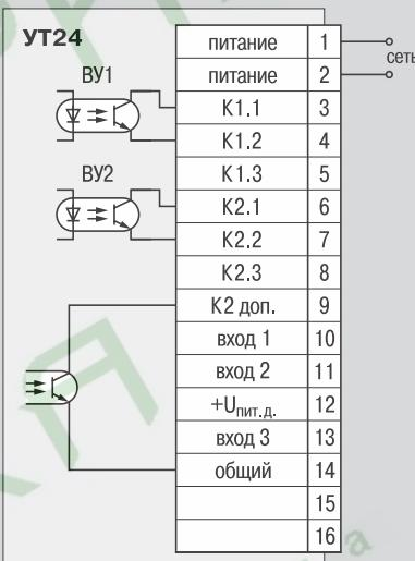
▲ Схема подключения прибора УТ24 с оптотранзисторным выходом
