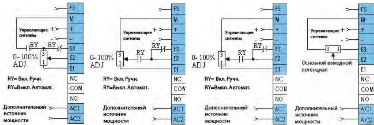
8. Подключение предустановки, только 1 для установки вне VR
