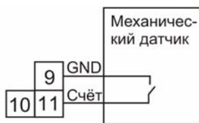
Рис. 2.5. Подключение датчиков с ОК
