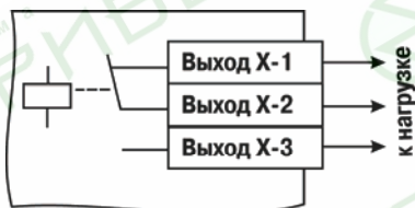
Рис. Б.2. Схема подключения к выходному элементу типа Р
