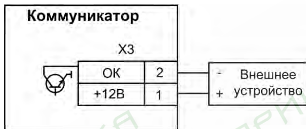
Рис.27 Схема подключения внешнего устройства к коммуникатору
