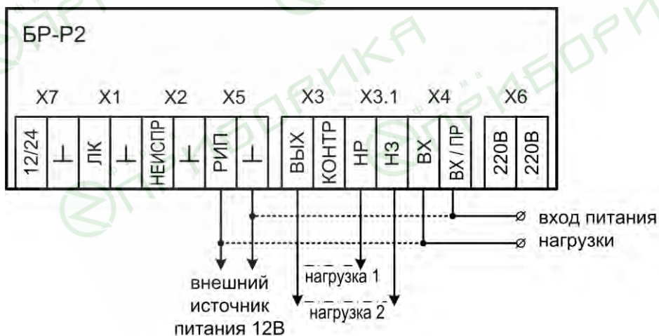
Рис.В9 Универсальная переключающая схема подключения. Питание BR-P2 от РИП 12В. Пунктиром показан вариант питания нагрузки от входа РИП BR-P2
