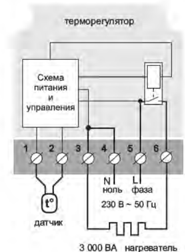
Схема 1. Схема подключения и упрощенная внутренняя схема
