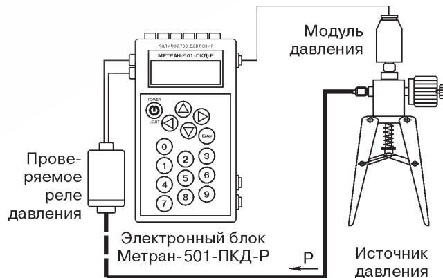
Рис. 3. Поверка реле давления.
