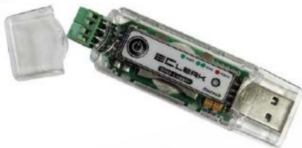
Рисунок 1 – Внешний вид автономного регистратора температуры и относительной влажности ECLIMAK® –USB-RHT
