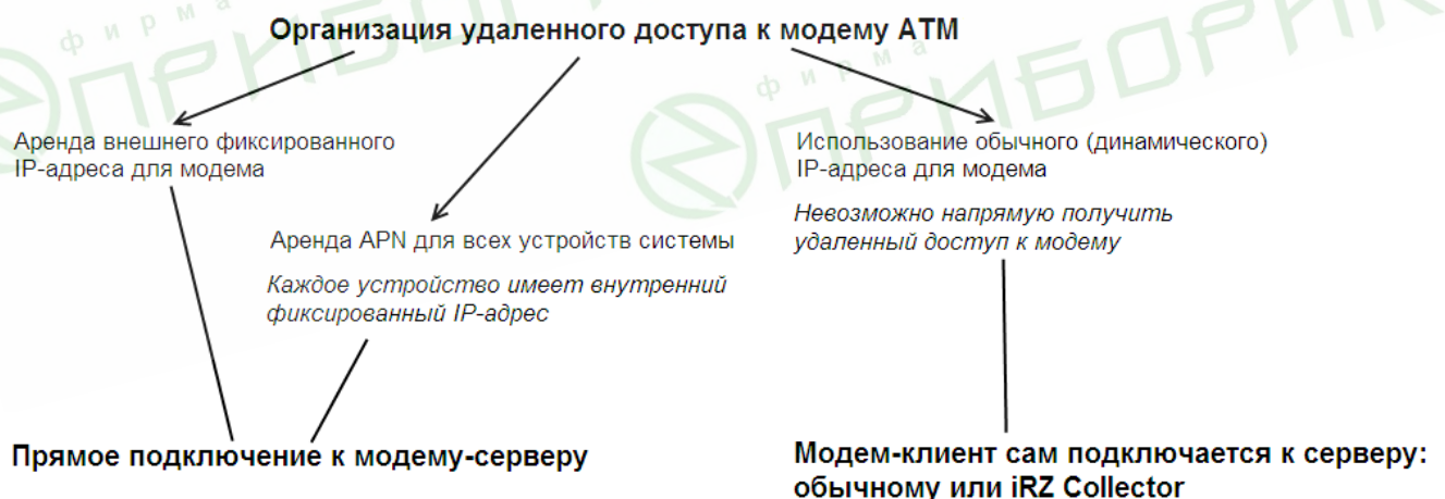
Рис. 4.5 Способы организации удаленного доступа к модему
