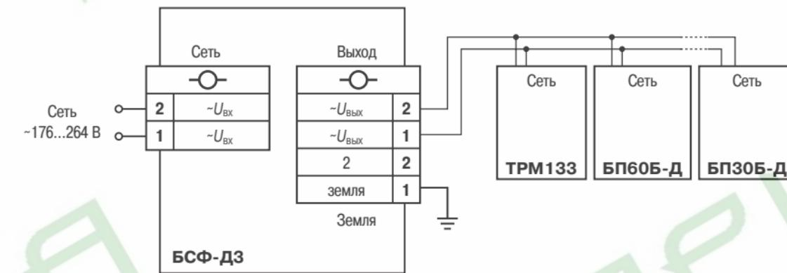
**Примечание.** Количество подключённых к блоку БСФ-Д3-1,2 приборов или блоков должно соответствовать максимальному току нагрузки 1,2 А.
