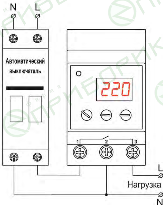
Рисунок 2 – Схема подключения изделия
