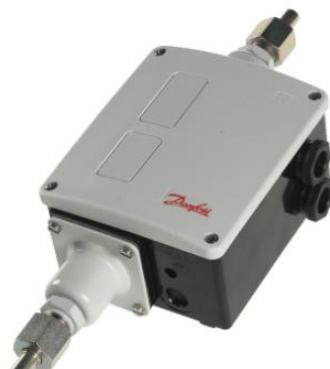
Дифференциальные реле давления сравнивают разность давлений, подводимых к реле, со значением уставки, устанавливаемой на приборе, и предназначены для регулирования, текущего контроля и аварийной сигнализации в промышленности и морском секторе. Устанавливаются в системах с жидкими и газообразными средами, а также паром.
