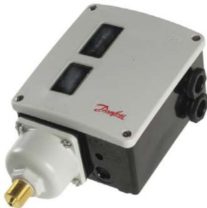
Реле давления типа RT предназначены для регулирования, текущего контроля и аварийной сигнализации в промышленности и морском секторе. Устанавливаются в системах с жидкими и газообразными средами, а также паром. Реле RT снабжены однополюсными выключателями, которые замыкают или размыкают электрическую цепь при изменении давления в системе по сравнению с заданным. Эта серия реле отличается высокой степенью защиты, надежностью и прочностью.
