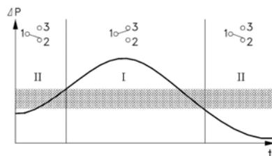
При превышении контролируемым давлением значения уставки размыкаются контакты 1 и 2 и замыкаются контакты 1 и 3. Обратное переключение происходит при падении давления до величины равной значению уставки минус значение дифференциала.
