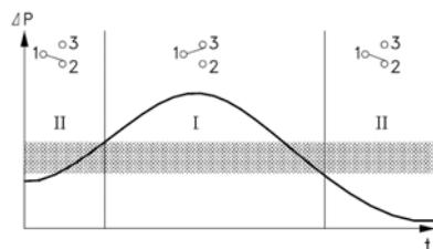
При превышении контролируемым температурой значения уставки размыкаются контакты 1 и 2 и замыкаются контакты 1 и 3. Обратное переключение происходит при падении температуры до величины равной значению уставки минус значение дифференциала.
