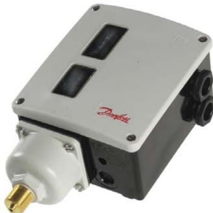
Реле давления типа RT-L предназначены для регулирования, сигнализации в промышленности и морском секторе. Устанавливаются в системах с жидкими и газообразными средами, а также паром. Реле RT-L предназначены для сигнализации как о падении, так и о повышении контролируемого давления.
