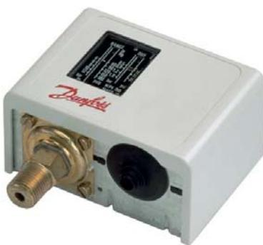
Реле давления типа KP/KPI предназначены для регулирования, текущего контроля и аварийной сигнализации в промышленности. Устанавливаются в системах с жидкими и газообразными средами. Реле давления снабжены однополюсными выключателями, которые замыкают или размыкают электрическую цепь при изменении давления в системе по сравнению с заданным.
