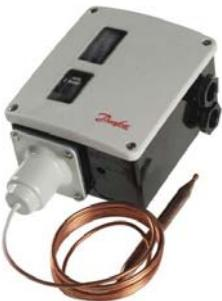
Реле температуры типа RT-L предназначены для регулирования, сигнализации в промышленности и морском секторе. Устанавливаются в системах с жидкими и газообразными средами, а также паром. Реле RT-L предназначены для сигнализации как о падении, так и о повышении контролируемой температуры.
