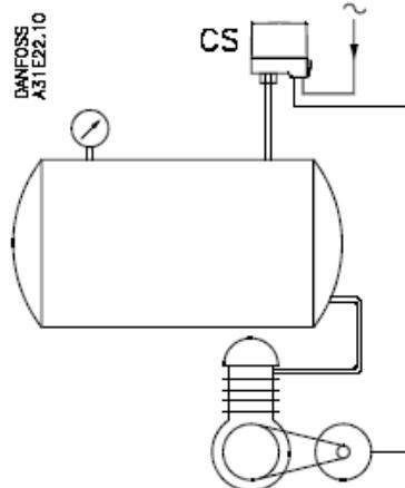
Управление воздушным компрессором с помощью реле CS с установленным перепускным клапаном. Обратите внимание на обратный клапан установленный между перепускной линией и резервуаром.
