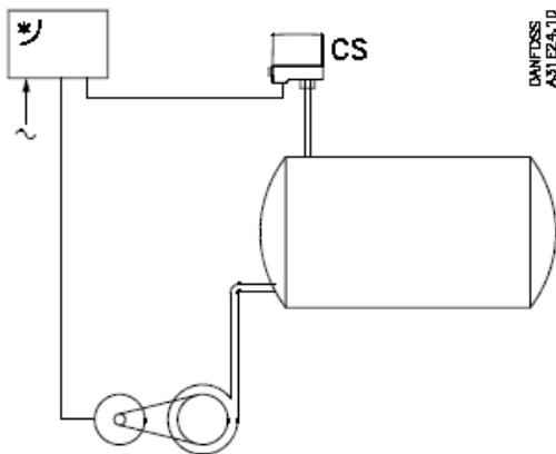
Управление насосом системы индивидуального домашнего водоснабжения (CS включает и выключает насос)
