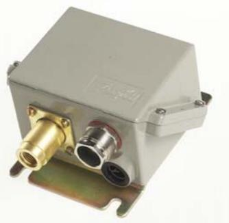
Реле давления типа CAS предназначены для регулирования, текущего контроля и аварийной сигнализации в промышленности и морском секторе. Реле CAS реагируют на падение давления ниже значения уставки. Приборы этой серии отличаются прочностью всех элементов конструкции и наличием моделей для систем с высоким давлением и пульсациями.
