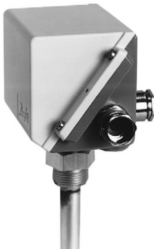
Двухшаговое реле температуры типа CAS предназначено для аварийной сигнализации и блокировки в промышленности и морском секторе. Реле имеет два перекидных контакта, которые настроены на различные значения уставок. Первый контакт переключается для включения предупредительной сигнализации, а второй для отключения всей системы.
