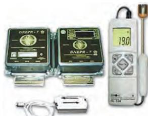
Комплект для организации учета сточных вод в трубопроводах среднего и большого диаметра. Комплектуется дополнительным датчиком уровня протекающей жидкости. Измеряет одновременно скорость потока и уровень наполнения.
