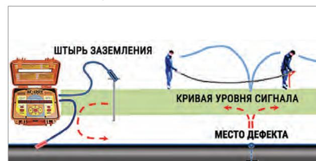
БЕСКОНТАКТНЫЙ СПОСОБ (с использованием датчика определителя дефектов коммуникаций ДОДК-117)
