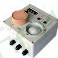
Непрерывный автоконтроль и выдача сигнализации о превышении установленных значений довзрывоопасных концентраций **метана** ( $\text{CH}_4$ ), горючих газов и паров горючих жидкостей в воздухе в условиях открытых пространств под навесами, в помещениях котельных, объектов общепромышленного назначения и т.д.
