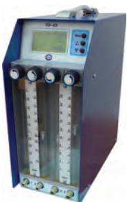
Автоматический отбор проб газов, паров и аэрозолей (в воздухе рабочей зоны, атмосферном воздухе и промышленных выбросах) для проведения санитарного и экологического контроля.
