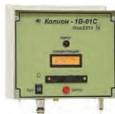
Выполнены в виде двух блоков: блока измерительного (БИ) и блока питания и выходных сигналов (БПВС). Выпускаются во взрывозащищенном исполнении для применения во взрывоопасных зонах, где по условиям эксплуатации возможно образование взрывоопасных смесей категорий IIA, IIB, температурных групп T1 – T4, имеет маркировку взрывозащиты 1ExibIIBT4. Устанавливается во взрывоопасной зоне.
