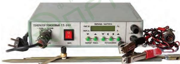
Генератор поиска ГП-500 мощностью 500Вт предназначен для **формирования мощного токового сигнала в диапазоне частот от 100 до 3000 Гц** необходимого при определении мест повреждения изоляции подземных трубопроводов.
