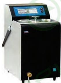
**Важной особенностью термостата ТПП-2.1 является высокие (нормированные) метрологические характеристики в приповерхностном слое, что позволяет поверять ТС с небольшой погружаемой частью.**
