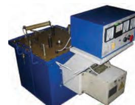
Блок прожигающий имеет 4 ступени выпрямленного напряжения (25; 5; 1; 0,3 кВ), которые подключаются к нагрузке через развязывающие диоды автоматически, в зависимости от сопротивления нагрузки.
