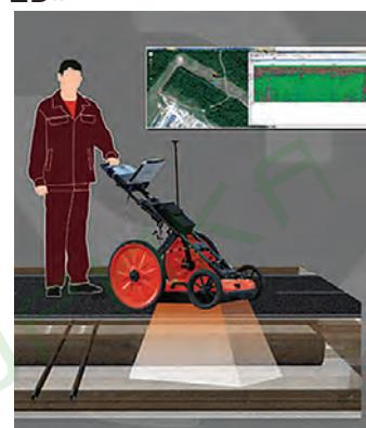
Предназначен для поиска скрытых подземных коммуникаций – трубопроводов, кабелей, коллекторов, дренажных сетей и прочее.
