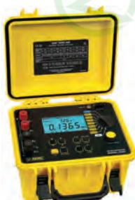
Использование 4-х проводной схемы измерения (сопротивление проводов исключается из результата).
