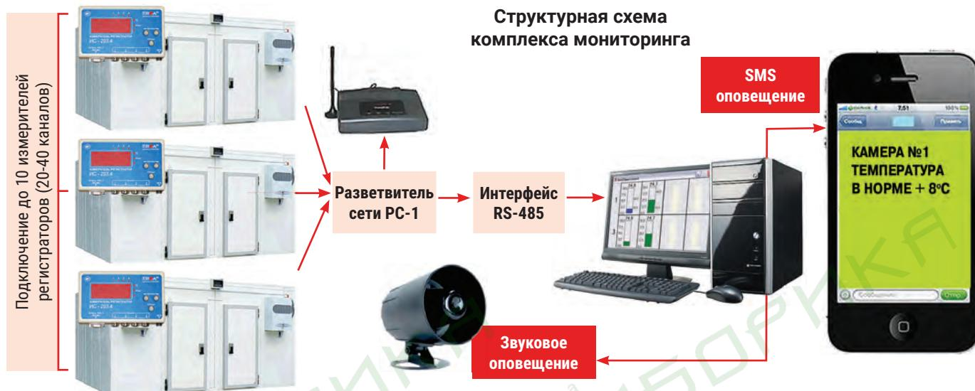
**Принцип работы:** управление мониторингом осуществляется с помощью программы, установленной на ПК, которая считывает с заданным интервалом результаты измерений с подключенных к сети измерителей регистраторов.
