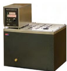
Термостат состоит из ванны, перемешивающего устройства, электронного блока (регулятора температуры). Перемешивающее устройство и регулятор температуры конструктивно исполнены в одном корпусе. Установка температуры осуществляется при помощи ручки управления. Дискретность задания температуры регулирования – 0,01°C.
