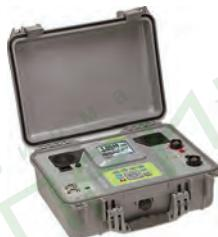
Регулируемый испытательный ток, который может принимать значения 100 мА, 1 А, 10 А, 50 А, 100 А.
