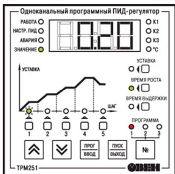
9 Для задания времени в течении которого прибор будет поддерживать температуру на уровне заданном уставкой (см. пп. 4 и 5) нажмите кнопку **ВРЕМЯ ВЫДЕРЖКИ**. При этом светодиод «ВРЕМЯ РОСТА» погаснет, а светодиод «ВРЕМЯ ВЫДЕРЖКИ» загорится. На цифровом индикаторе отобразится текущее значение времени выдержки на первом шаге.
