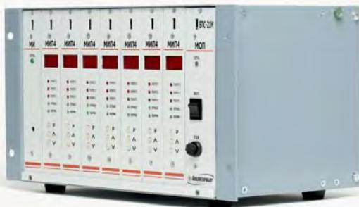
Предназначен для питания датчиков-сигнализаторов ДАТ-М, датчиков-газоанализаторов ДАХ-М, ДАК, ДАМ, ДАФ-М, анализаторов активности ионов потенциометрических АП430-02, Анкат-7655-02; > измерения входных токовых сигналов от датчиков по каждому каналу; > выдачи световой и звуковой сигнализации при превышении/понижении установленных пороговых значений с одновременным переключением «сухих контактов» реле.
