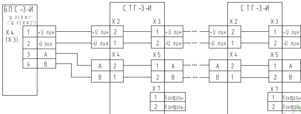
**Схема шлейфового подключения сигнализаторов СТГ-З к блоку БПС-З и дополнительного источника питания**
