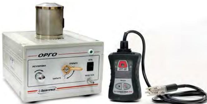
Предназначен для регулируемого разбавления природного газа воздухом при определении интенсивности запаха природного или сжиженных газов органолептическим методом по ГОСТ 22387.5-14. По определенной с помощью ОРГО интенсивности запаха возможна калибровка в баллах индикатора интенсивности запаха ИЗО-Микро.
