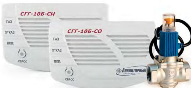
Предназначена для непрерывного автоматического контроля содержания природного или сжиженного газов по BS EN 5091-1-2010+F1-2012 и оксида углерода по ГОСТ ЕН 50194-1 в воздухе контролируемых помещений; выдачи световой и звуковой сигнализации в случае возникновения пороговых значений; перекрытия газопровода быстродействующим электромагнитным клапаном.
