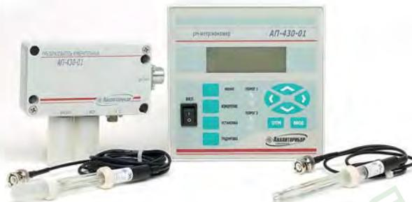
АП-430, АП-430-01, АП-430-02 предназначены для непрерывного измерения активности ионов водорода, ионов натрия, ионов калия и других ионов и катионов, окислительно-восстановительного потенциала и температуры водных растворов.
