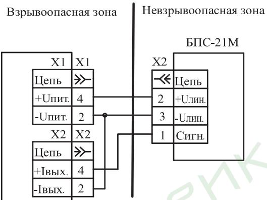
**Подключение датчиков ДАХ-М-06ТРХН, -06ТР, -06ТРХ; ДАРТ; ДАК-26...-30, -35...-38, -126...-139; ДАТ-М-06, -06Г, -06ТР, -06ТРХ, -06ТРХН, -06ГТР, -06ГТРХ, -06ГТРХН; ДАФ-М-06ТРХ к БПС-21М-М**
