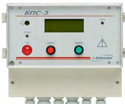
Предназначен для питания сигнализаторов СТГ-3 и СТГ-3-И при их соединении в шлейф, выдачи световой и звуковой сигнализации при срабатывании любого сигнализатора в шлейфе, с одновременным переключением «сухих контактов» реле по двум порогам.
