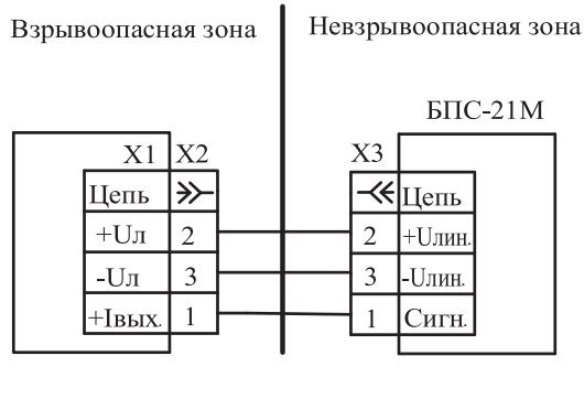
**Подключение датчиков ДАХ-М-05, -05Х, -06ТР, -06ТРХ; ДАТ-М-05, -05Х, -05Г, -05ГХ; ДАК-26...-30, -35...-38, -126...-139; ДАФ-М-05Х к БПС-21М**
