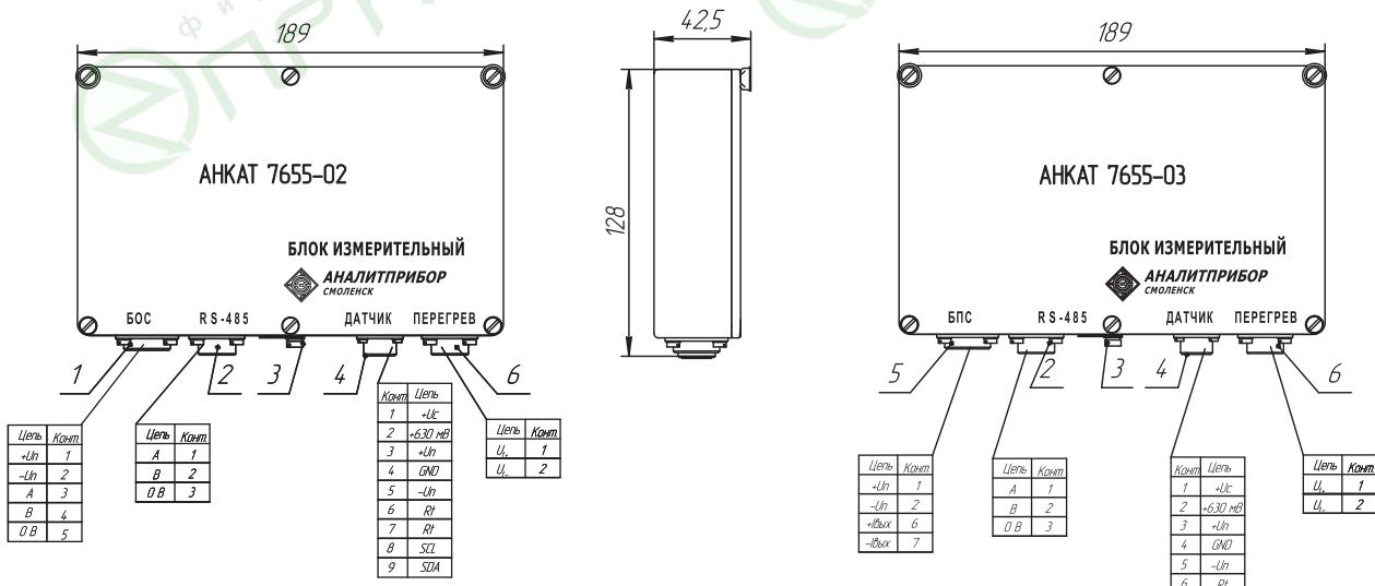
1 - разъем "БОС" для подключения к блоку обработки сигналов;
