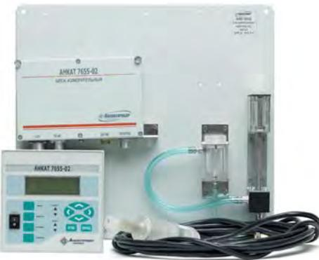
Предназначен для автоматического непрерывного измерения массовой концентрации растворенного кислорода в водной среде при контроле водно-химического режима котлоагрегатов на предприятиях электро- и теплоэнергетики и других отраслей промышленности.
