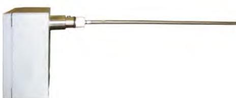
Пылемер – моноблочный прибор в металлическом корпусе, с погружным датчиком-стержнем, крепящимся к корпусу через изолят. Длина погружной части 750, 1000 обеспечивается стержнем-насадкой к базовой длине, равной 500 мм. Длина погружной части 1500 мм обеспечивается двумя дополнительными стержнями-насадками длиной 500 мм каждая к базовой длине, равной 500 мм.
