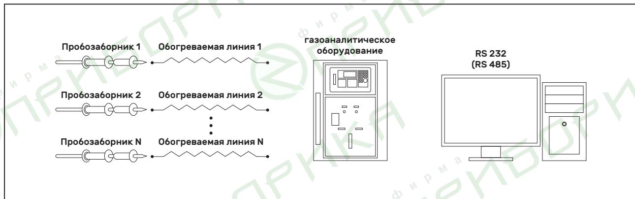
КГО в зависимости от поставленной задачи формируется индивидуально в различной комбинации и состоит из функционально законченных изделий, позволяющих формировать структуру данной газоаналитической системы в зависимости от выполняемых функций, условий эксплуатации, характеристик анализируемой среды, специфических требований заказчика и др.
