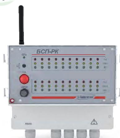
Предназначен для приема по радиоканалу информации от сигнализатора горючих газов СГГ10-Б-РК, передачи этой информации по каналу GSM и выдачи дублирующей световой и звуковой сигнализации, соответствующей состоянию сигнализаторов.
