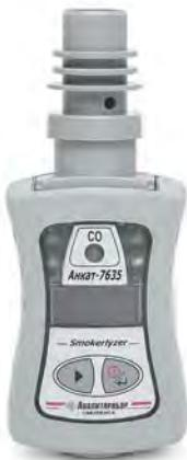
Предназначен для определения содержания оксида углерода (CO) в выдыхаемом воздухе, пересчета в единицы содержания карбоксигемоглобина в крови пациента (% HbCO), выдачи световой и звуковой сигнализации при превышении установленных пороговых значений.
