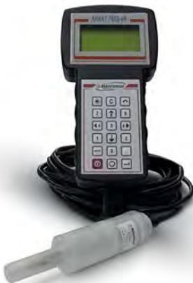
Предназначен для автоматического измерения массовой концентрации растворенного кислорода и температуры в водной среде для контроля водно-химического режима котлоагрегатов на предприятиях электро- и теплоэнергетики и других отраслей промышленности.
