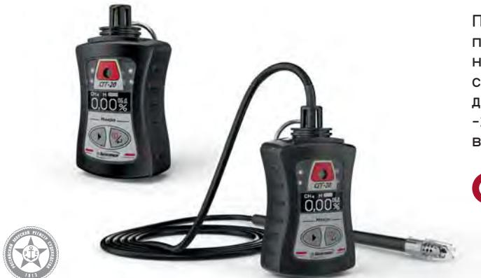
Предназначен для обеспечения безопасности персонала от риска возникновения довзрывоопасных концентраций многокомпонентных воздушных смесей горючих газов и паров с воздухом. А также для обнаружения мест утечек сжиженного (по ГОСТ -20448-90) и природного (по ГОСТ 5542-2014) газов, водорода и других горючих углеводородных газов.
